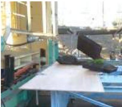
従来のトレー式は板状で硬い素材のため風の影響を受けやすく、少しでも浮き上がると一気に強風に飛ばされてしまいます。常緑キリンソウ袋方式®は柔らかく変形が可能、しかも風をわずかながら通すので、浮力が発生しにくく飛びにくい構造になっています。
